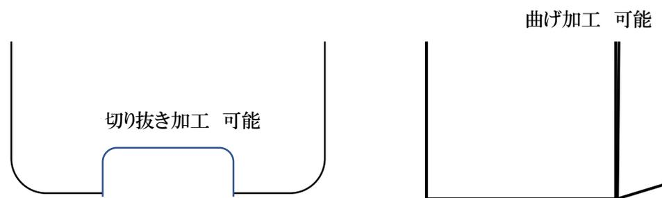
※PET製品も、図のように切り抜き、曲げ加工が可能です。
